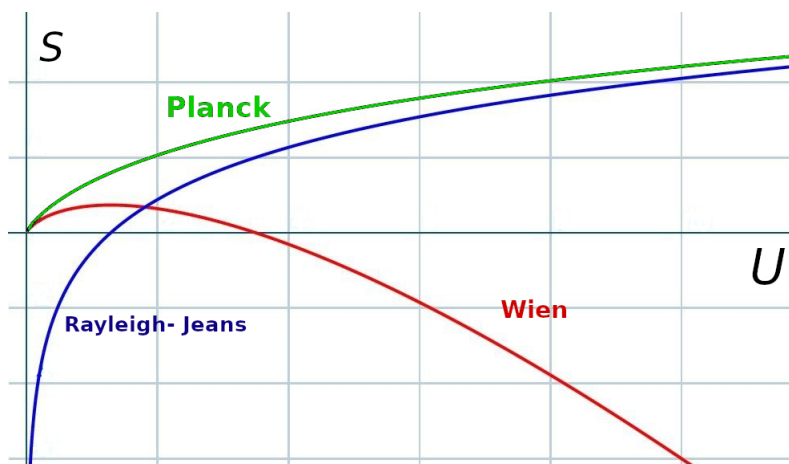
Figura 3: entropia di un singolo oscillatore armonico secondo la meccanica Newtoniana , l' elettromagnetismo classico e la meccanica quantistica .
